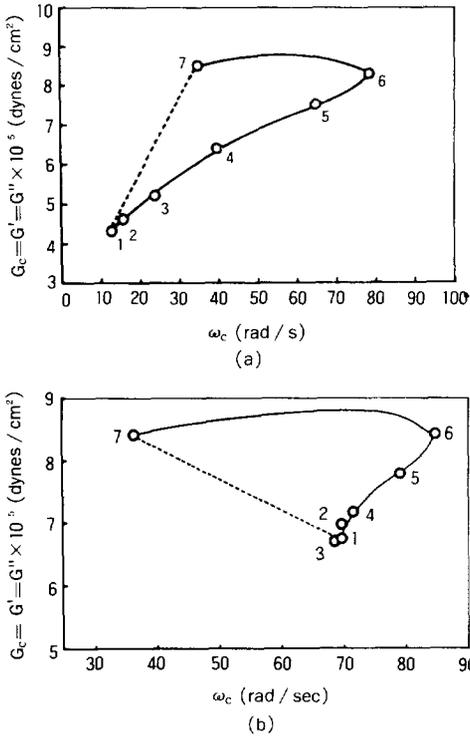
Fig. 10. Coordinates of  $G_c = G' = G''$  crossover point :  $G_c$  vs.  $\omega_c$  for PE-A / EPM(a) and PE-B / EPM (b) blends : PE-A / EPM=100 / 0(1): 90 / 10(2): 80 / 20(3): 70 / 30(4): 60 / 40(5): 50 / 50(6): 0 / 100(7): PE-B / EPM=100 / 0(1): 90 / 10(2): 80 / 20(3): 70 / 30(4): 60 / 40(5): 50 / 50(6): 0 / 100(7).
